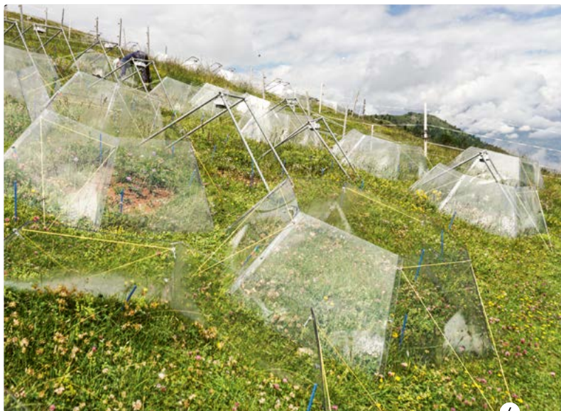
4 Käfige aus Plexiglas simulieren die Zukunft: In ihrem Inneren sind die Temperaturen höher als in der Umgebung.
