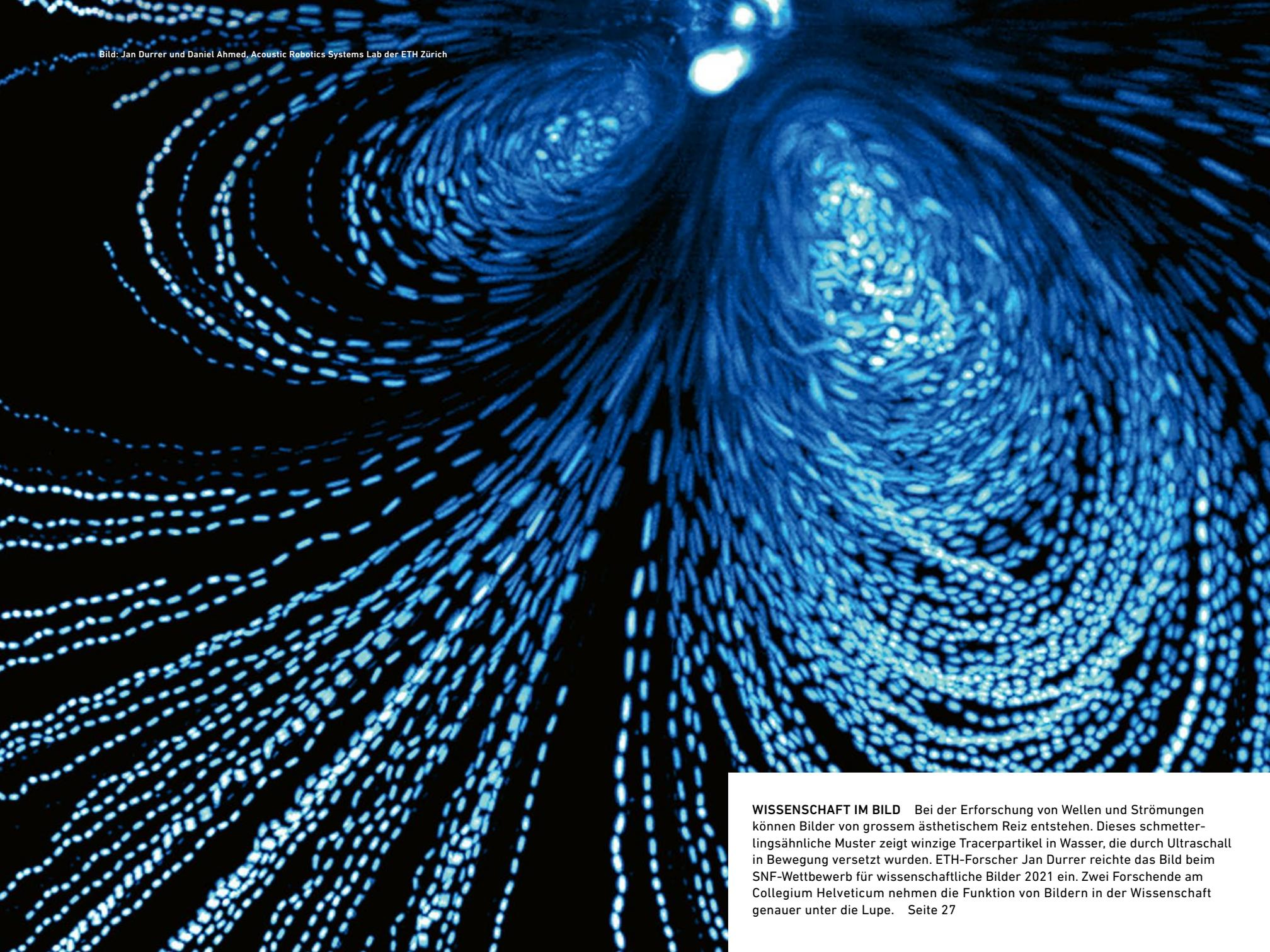
**WISSENSCHAFT IM BILD** Bei der Erforschung von Wellen und Strömungen können Bilder von grossem ästhetischem Reiz entstehen. Dieses schmetterlingsähnliche Muster zeigt winzige Tracerpartikel in Wasser, die durch Ultraschall in Bewegung versetzt wurden. ETH-Forscher Jan Durrer reichte das Bild beim SNF-Wettbewerb für wissenschaftliche Bilder 2021 ein. Zwei Forschende am Collegium Helveticum nehmen die Funktion von Bildern in der Wissenschaft genauer unter die Lupe. Seite 27
