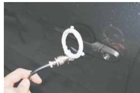
Eine Antenne, aus einem simplen Draht geformt, genügt, um die Signale vom Auto auf das Sendergerät zu übertragen. (Bild: ETH Zürich)
