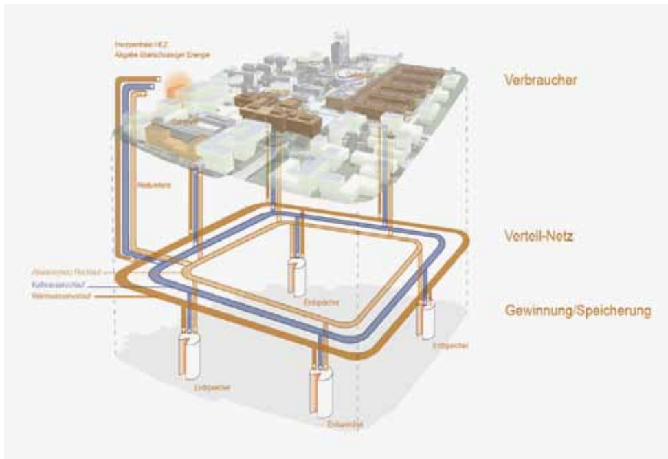
Schematische Darstellung des Erdwärmesystems Science City. (Bild: Amstein + Walthert AG)
